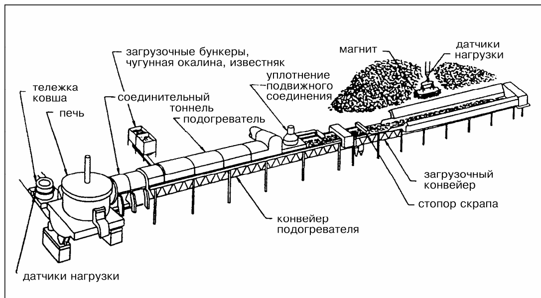
Рис. 9.16. Схема процесса "констил" – [Валломи, 1992]
