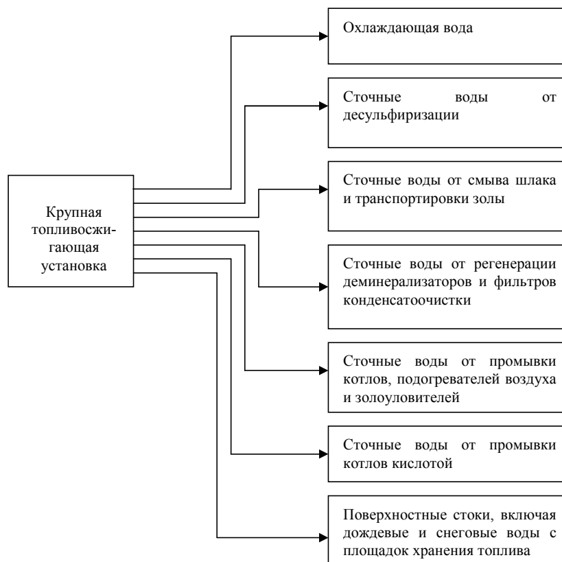
Рисунок 1.8: Виды сточных воды от крупной топливоиспользующей установки
